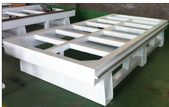
Сверхпрочная стальная сварная рама
